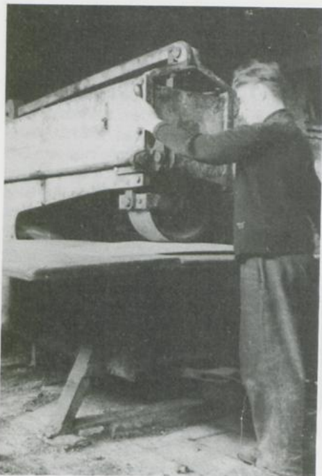
Walzen des Sohlleders zum Herstellen von Schuhsohlenleder
